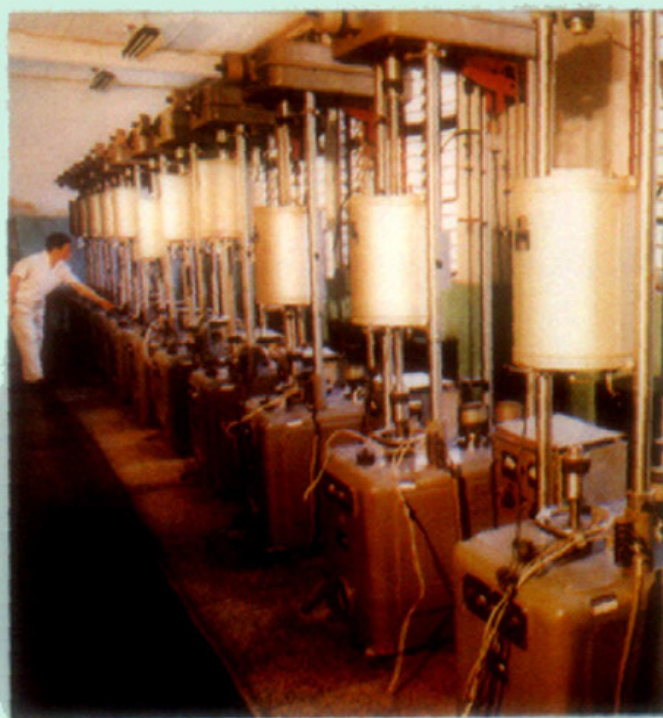
▲金属材料持久蠕变试验
